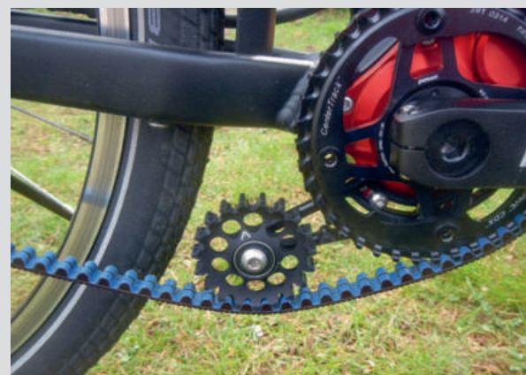
De riem wordt op spanning gehouden met een spanwiel. Dat is volgens Santos een betere oplossing dan schuifpatten of een verplaatsbare Pinion.
